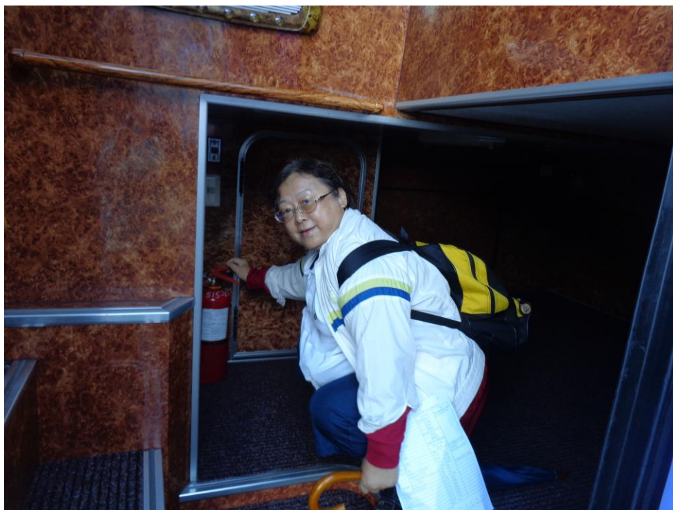
說明：檢查車上逃生口與逃生設備 3
